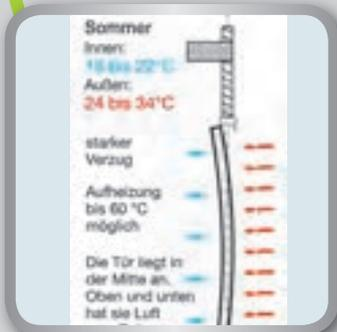
VERZUGSHEMMEDES FLÜGELPROFIL Dadurch werden Dichtigkeit und Schließbarkeit der Tür bei extremen Temperaturen wesentlich verbessert.
