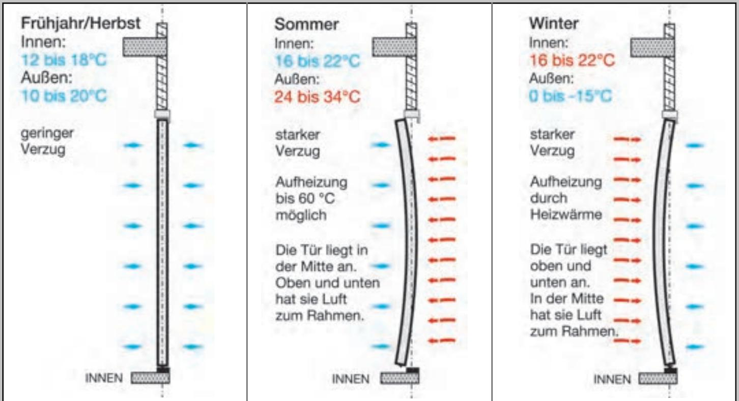
Bi-Metalleffekt: Durchbiegung des Türflügels bedingt durch hohe Temperaturunterschiede.
